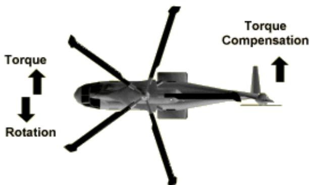
Le rotor anti couple consomme en viron 10% de la puissance moteur. Il est bruyant, il est dangereux, il est sensible au vent de travers, il est couteux, il est fragile. Toutes ces raisons font que les constructeurs cherchent à l'optimiser et/ou si possible l'éviter.
